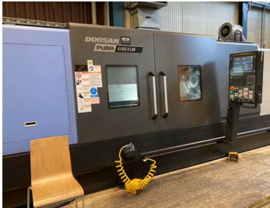
Nova Puma 5100 XLM za obdelavo torzijskih osov, s katero pri obdelavi združujemo več operacij in s tem zagotavljamo boljšo kakovost izdelka.
