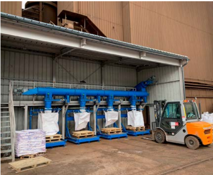
Januarja 2021 smo napolnili 630 velikih vreč ('big bag'), vanje smo ujeli 530 ton prahu.
