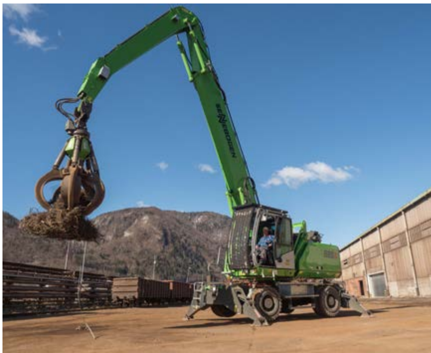
Z novim strojem za manipulacijo odpadkov lahko v eni uri preložimo 10 t več materiala kot s starim strojem.
