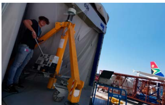
Naprava za preverjanje nosilnosti stojk, izdelana v družbi SIJ Ravne Systems. Peter jo uporablja kot potisno enoto za kalibracijo dinamometrov.
