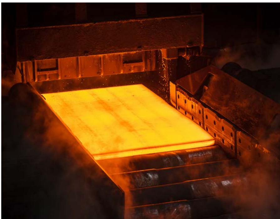
Valjanje debele pločevine iz jekla SIDUR 400
