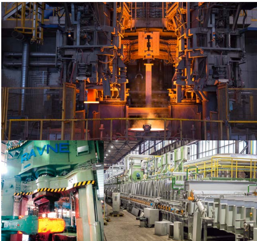
Rast proizvodnje je zagotovila 25-MN stiskalnica, ki so jo postavili leta 2000, v prvem desetletju Metala.
