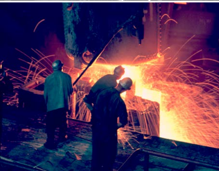
Klasično ulivanje 8-tonskih bram kmalu pred zaustavitvijo obrata
