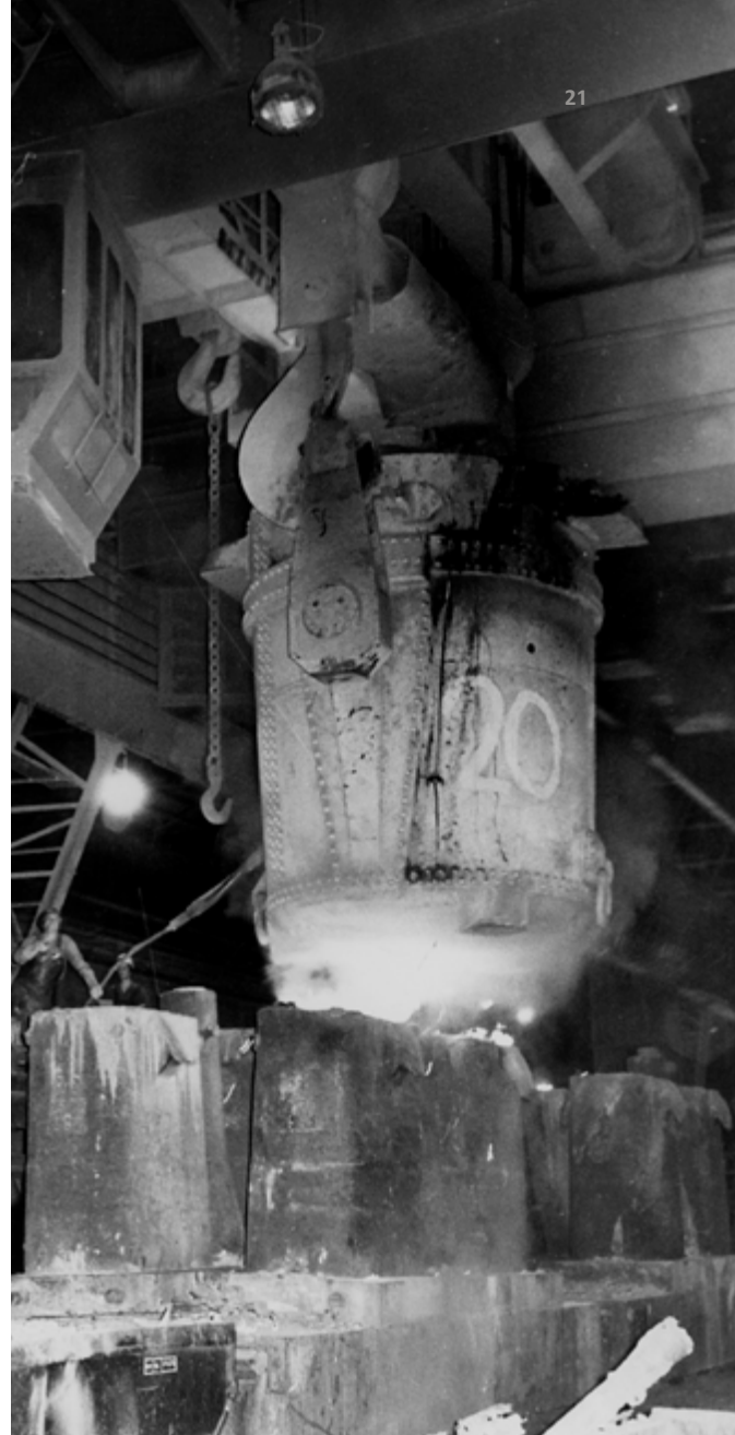
Ulivanje jekla na livne vozove v Jeklarni I 27. oktobra 1977
