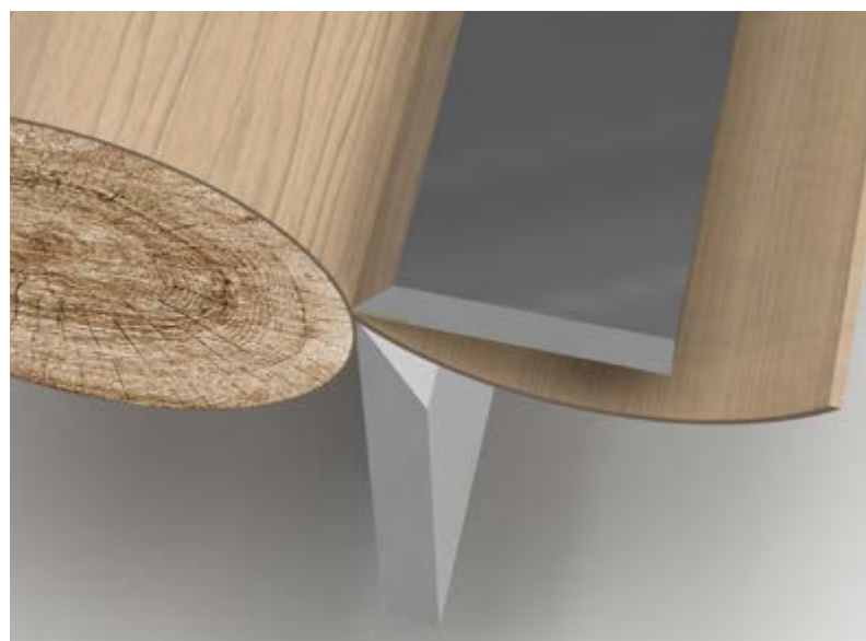
Daljša življenjska doba nožev pri visokih hitrostih rezanja je povezana z ustrezno mikrostrukturo materiala rezila. Prav tako morajo imeti ti noži visoko in konstantno trdoto, trdnost, žilavost, visoko obrabno obstojnost in rezilnost.
